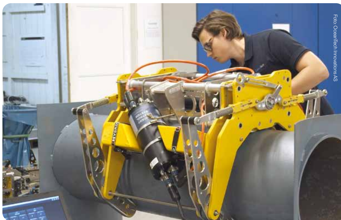
Verksted-montering av OceanTech inspeksjonsrobot
