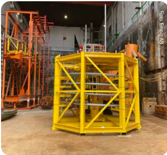
Bildet viser kjøleren i tørrdokk i Trondheim der det mekaniske systemet nylig ble kvalifisert i en shallow water test.
