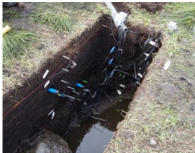
Installert måleutstyr for langtidsovervåking av kulturlag i grøften på gårdshaugen Voldstad, Harstad kommune. Foto: Vibeke Martens, NIKU
