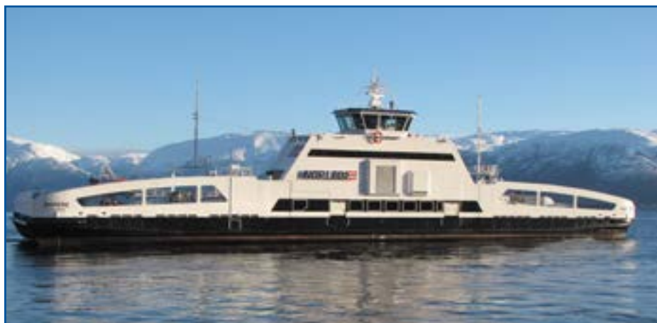
Verdens største batteridrevne ferge er bygget for lavt energiforbruk, og frakter biler og passasjerer på E39-sambandet over Sognefjorden – helt uten motorstøy! Foto: Fjellstrand AS
