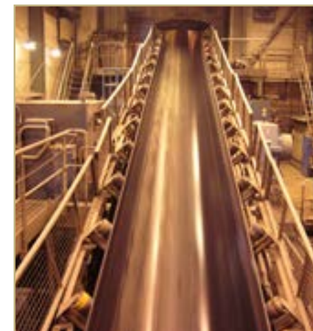
Komposittrullene ligger under transportbåndet og sørger for at det går rundt. Her ser du enden av rullene som stikker opp på hver side av båndet. Foto: Narvik Composite AS
