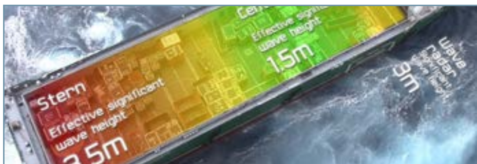
Illustrasjonen viser hvor store forskjeller det kan være for de faktiske hiv-bevegelsene på ulike deler av dekk for en supplybåt. Foto: OptiLift AS
