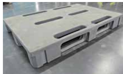
Plastpallene til Norsk Lastbærer Pool, som brukes i IMSIS-prosjektet, har en innstøpt RFID-brikke i alle fire hjørner. Foto: Coop
