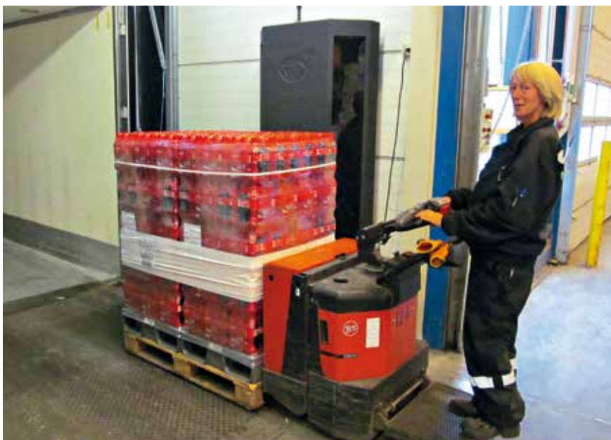
Vareleveranse på Coops regionallager i Trondheim. Varen blir automatisk tilgjengelig for kunden i det pallen passerer antenna i den store, sorte boksen ved veggen. Foto: Coop
