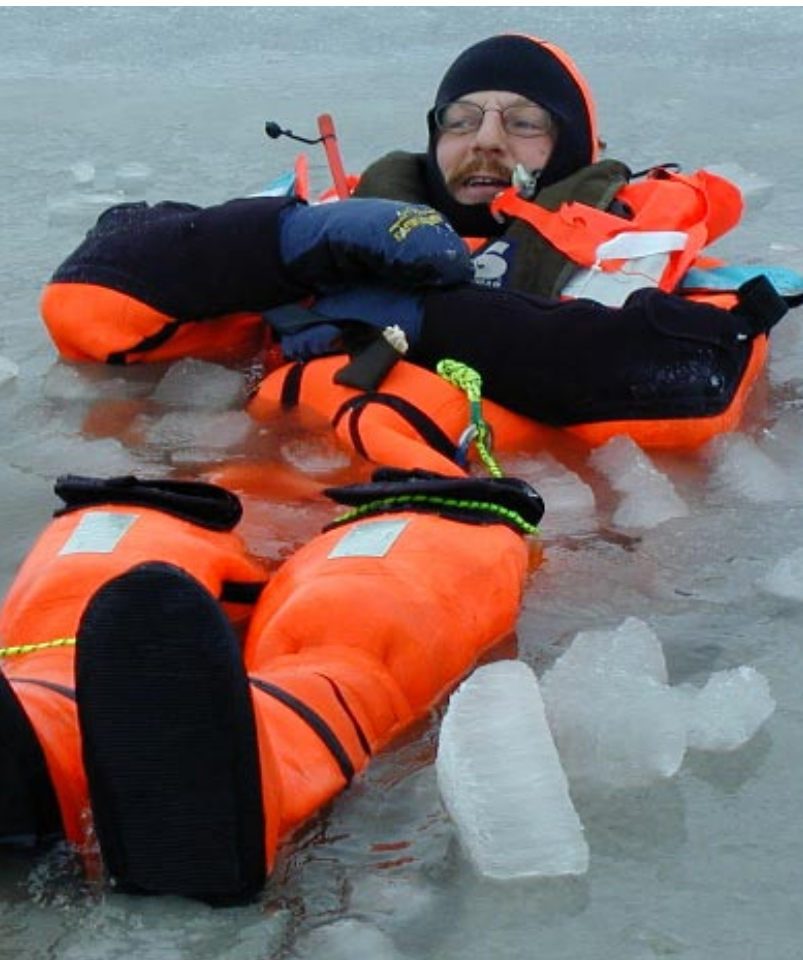
Smarte materialer i drakten utløser varme når piloten havner i sjøen. Foto: SINTEF
