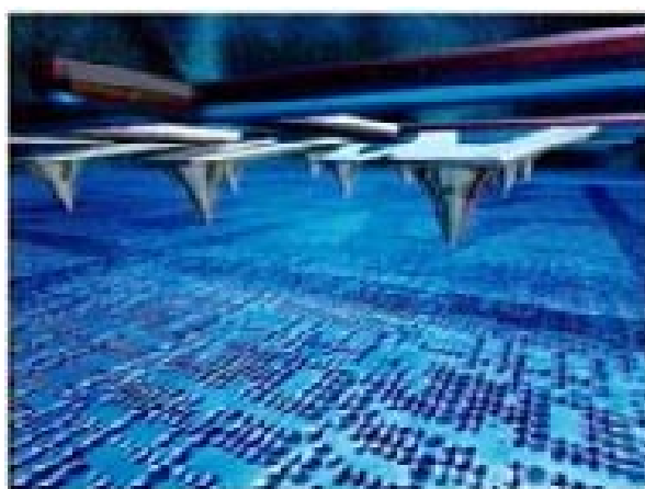
Nanohull i en polymer gjør det mulig å lagre 1000 gigabyte på en brikke. Ill: IBM
