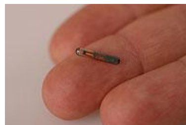
ID-brikke som settes inn i fiskens buk. Brikken inneholder en radiosender som sender signaler til datasystemet.
